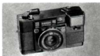
«Эликон-автофокус» — фотоаппарат с автоматической фокусировкой объектива. Автофокусировка осуществляется в так называемом «пассивном» режиме («СФ», 1982, № 11) специальным электронным блоком, сравнивающим сигналы от двух пятиэлементных фотоприемников. Программный затвор автоматически обрабатывает экспозицию от 1:2,8—1/8 до 1:16—1/500 с. При работе со встроенной лампой-вспышкой диафрагма объектива устанавливается автоматически, в зависимости от расстояния до снимаемого объекта.
