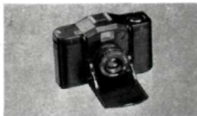
«Эликон-1» — дальнометрический фотоаппарат бесфутлярной конструкции. Автоматическая обработка выдержки в диапазоне 10—1/500 с с произвольным выбором диафрагмы. Объектив 1:2,8/35 мм с внутренней фокусировкой. Приставная лампа-вспышка работает в автоматическом режиме и управляется по отраженному от объекта световому потоку.
